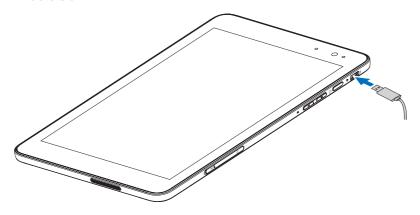
**3** Schließen Sie den Netzadapter an eine Netzsteckdose an, und laden Sie das Tablet so lange auf, bis der Akku vollständig geladen ist.
